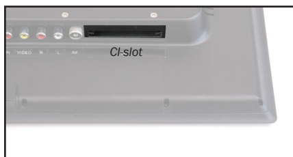
Placering af CI-slot (Card Interface) på bagsiden af INVATEC M19-DVD5.
